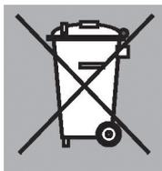
为表明家用电器分类收集的要求，本电器带有一个打叉垃圾桶的标志。这意味着电器使用寿命结束后，不可作为城市垃圾处理。必须交由当地政府机构运营的专门的垃圾收集中心，或者交由提供该项服务的商家。单独处置这样的炉类家用电器，可以避免因处置不当而对环境和健康造成负面后果，可以将制造材料加以回收，大量节约能源和资源。
