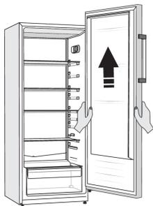
小心地垂直向上将门提起，将其从底部铰链上卸下。将门放置在光滑的表面上。
