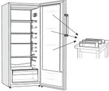
将冰箱垂直放置。开门并卸下门架（以防止在操作过程中损坏门架）。然后，关门。
